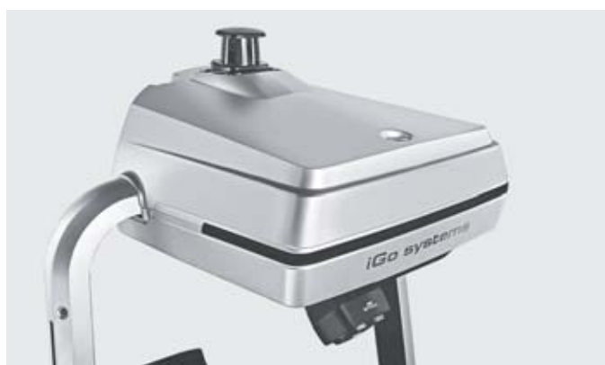
Déplacement automatique : vos LTX 50 iGo circulent sans assistance dans vos locaux grâce à leur module de commande automatique couplé à une navigation laser
