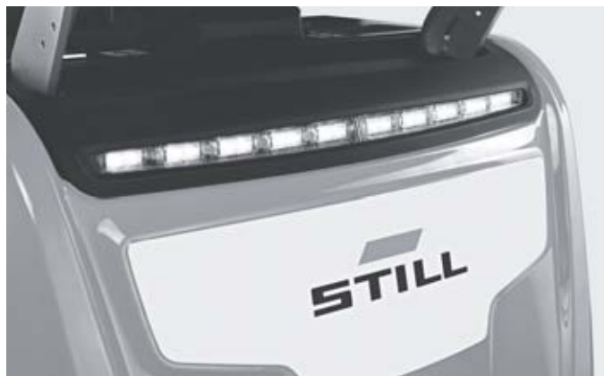
Feux de jour à LED en option, pour une meilleure visibilité de l'appareil et une plus grande sécurité du travail 2
