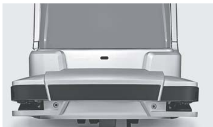
Protection des personnes à 360° : scanners laser de sécurité intégrée au système LTX 50 iGo Systems
