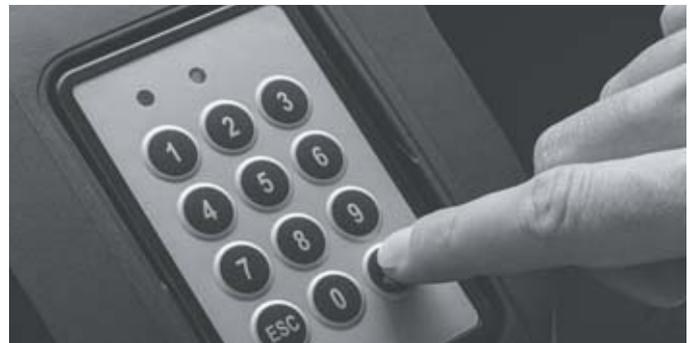
Autre possibilité, l'entrée par le cariste, à l'aide d'un clavier installé sur le chariot, d'un code PIN de cinq à huit chiffres l'identifiant personnellement. Et en fin de poste, pour se déconnecter, une simple pression sur la touche «Sortie» du clavier suffit.
