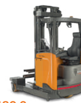
R489 6 Chariot à poste de conduite élevé (plancher = 1.2m)
