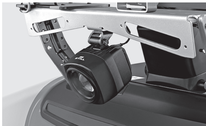
Meilleure prise en compte du chariot dans son environnement pour une sécurité maximale avec le feu de sécurité STILL Safety Light en option
