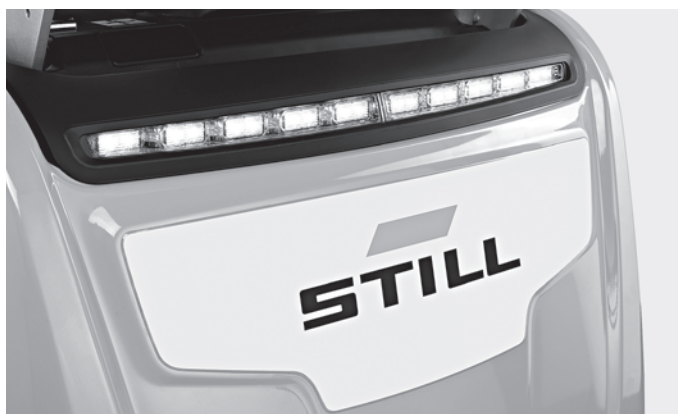
Visibilité accrue du chariot grâce à des feux de jour à LED intelligents – qui indiquent également un état de faible charge batterie
