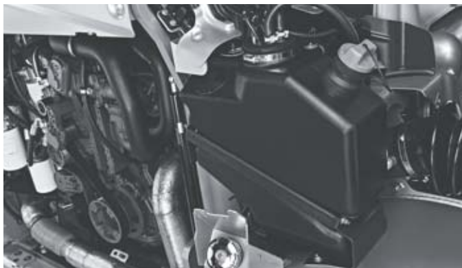
Réservoir Ad Blue pour le post-traitement des gaz d'échappement
