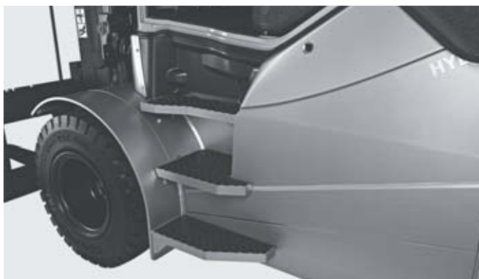
Montée à bord et descente sécurisées grâce à un large marche-pied antidérapant
