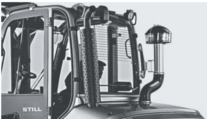
Filtre cyclonique purifiant l'admission d'air du moteur
