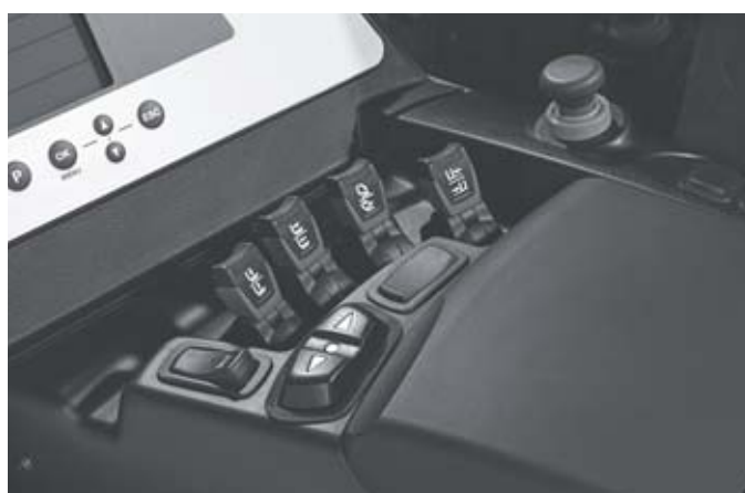
Pilotage simple de toutes les fonctions sans changement de position de la main - par à l'aide quatre mini-levers (Fingertip)
