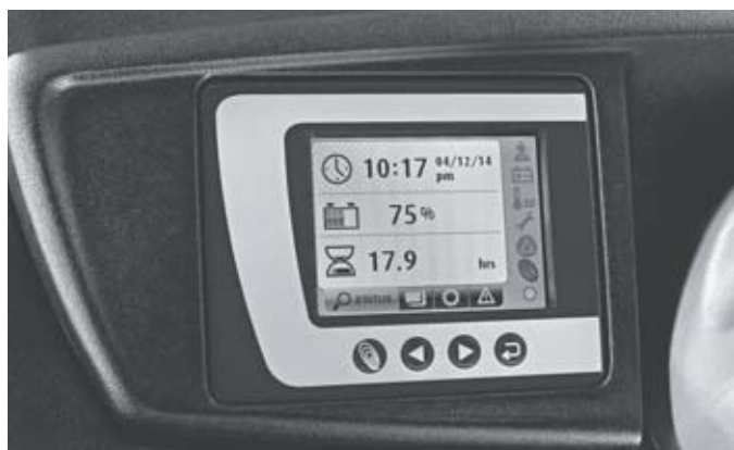
Afficheur couleur intégré au pupitre montrant la charge de la batterie, le sens de marche et autres informations pertinentes
