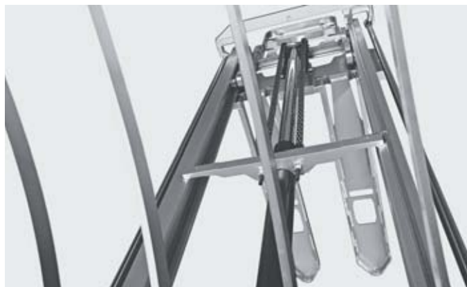
Visibilité optimale lors des stockages et déstockages grâce à une conception profilée du toit de protection conducteur
