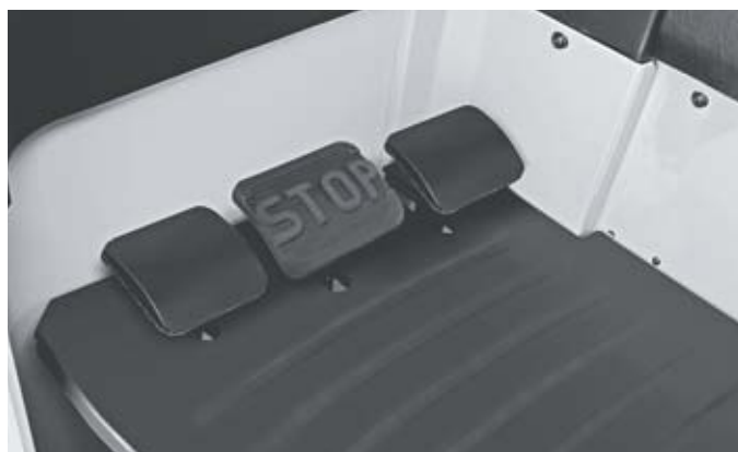
Précision totale jusqu'à la pointe des orteils avec un pédalier spécial optimisé pour un changement de direction rapide et sûr
