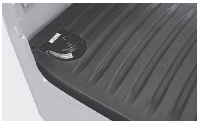
Plancher suspendu préservant le dos du cariste lors des longs trajets
