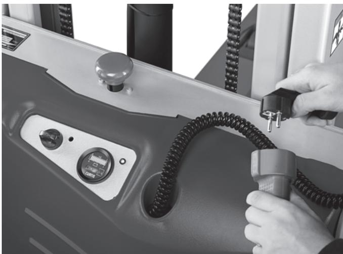
Chargeur intégré garantissant une disponibilité maximale (en permettant une recharge n'importe où dans l'entrepôt)
