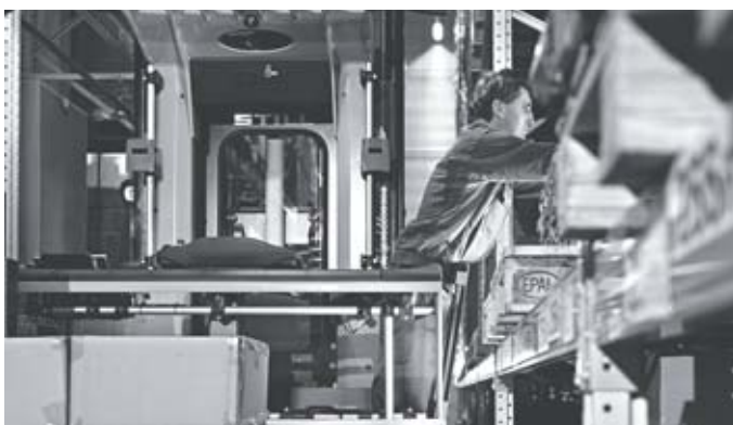
Portillon inclinable assurant une haute ergonomie lors des prélèvements des colis en bout de palette
