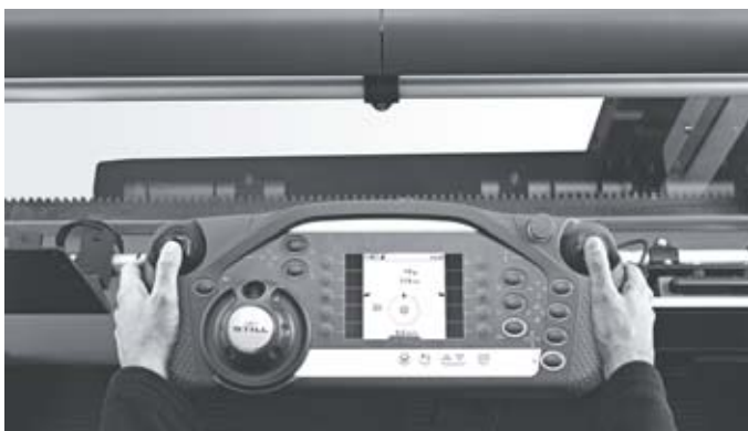
Pupitre de commande compact et ergonomique avec écran couleur affichant des messages d'assistance conducteur
