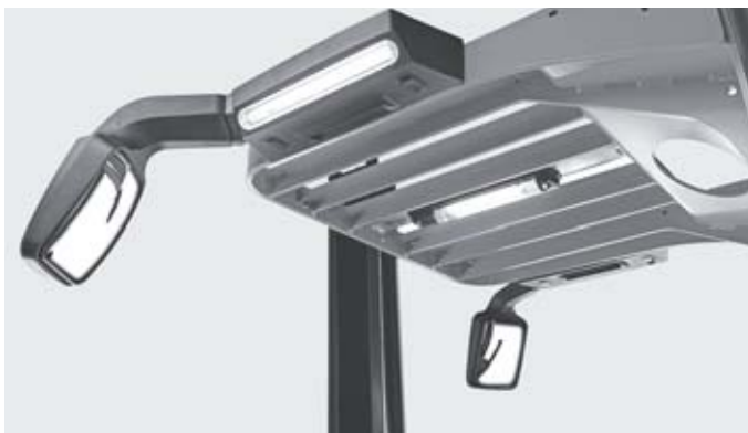
Rétroviseurs à réglage séparé pour un accès facile en allée étroite
