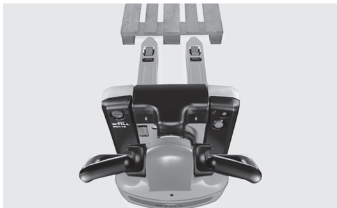
La compacité du transpalette permet une meilleure visibilité sur les fourches
