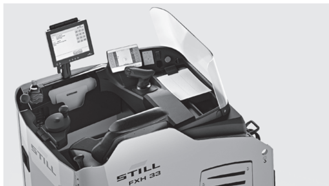
Positionnement simplifié du terminal informatique et autres équipements en option grâce à des rails porte-accessoires intégrés
