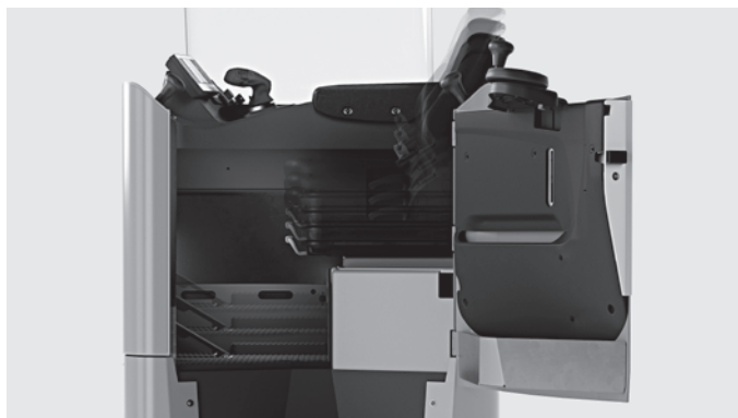
Travail ergonomique grâce au plancher réglable en hauteur s'adaptant à toutes les corpulences
