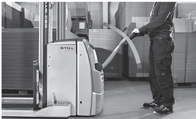
La sécurité de série : la vitesse s'adapte automatiquement à l'angle du timon et ainsi de la distance séparant l'opérateur du chariot <sup>1,2</sup>
