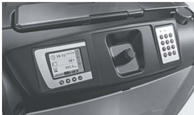
Écran couleur avec un ensemble complet d'icônes universellement compréhensibles montrant toutes les fonctions importantes d'un coup d'œil
