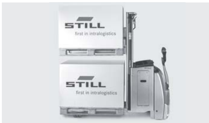
Capacité de manutention élevée grâce au transport simultané de deux supports de charge non empilables
