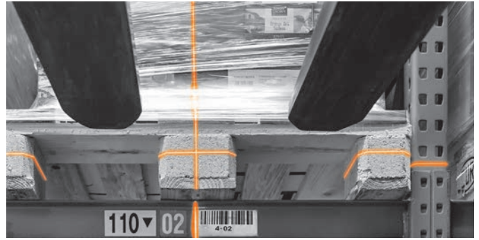
Laser transversal en option pour aligner le centre de la palette en toute sécurité
