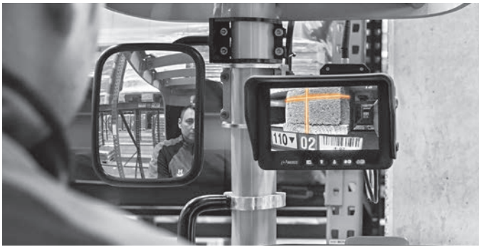
Système de caméra en option pour une visibilité optimale lors du chargement et du déchargement
